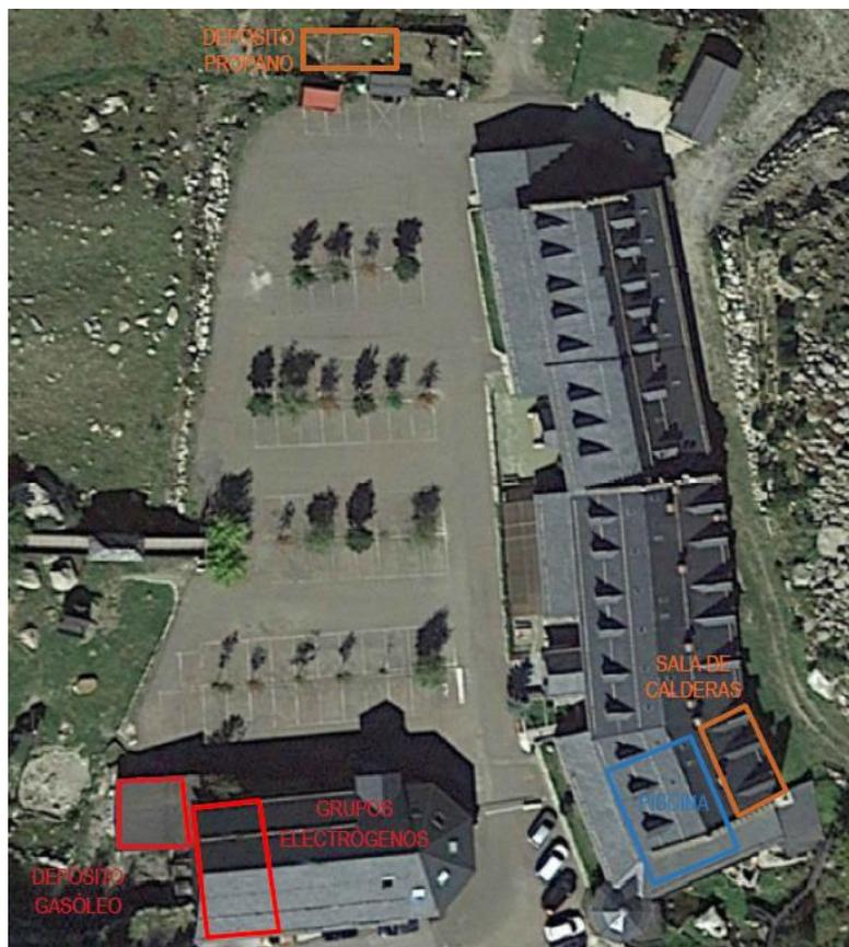
Figura 9. Layout actual de la instalación de generación de electricidad y calor del hotel.
