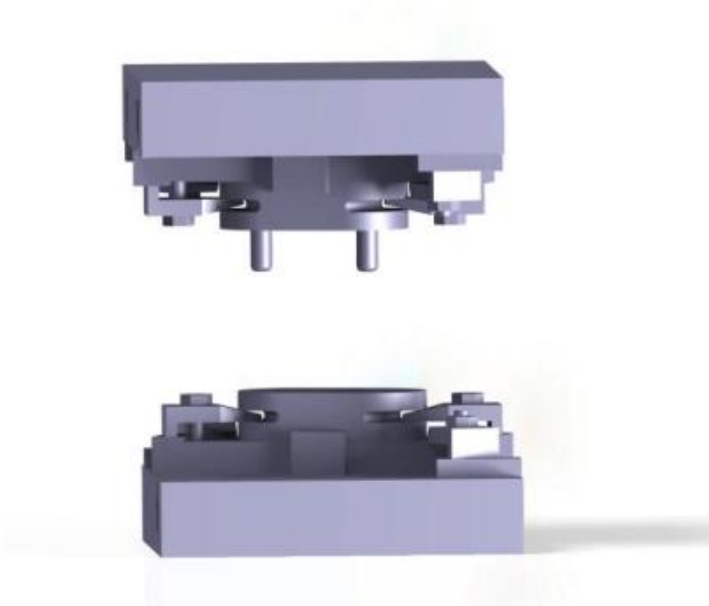
34 Figura 5.2.11. Maqueta 3D de la estampadora (6)
