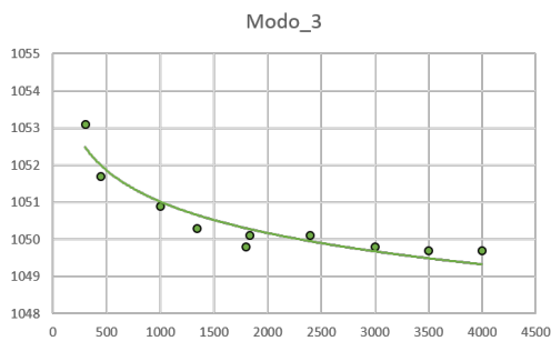
(c) Evolución de la frecuencia del modo 3 con la resolución de la malla.
