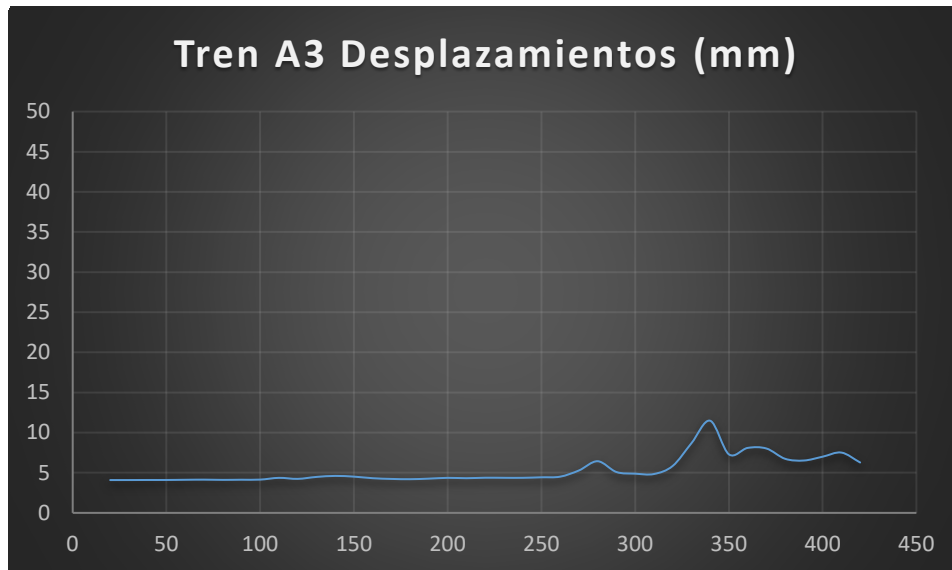
Figura 4.103 - Desplazamientos máximos tren A3 en arco de 100m de luz y relación 1/7.07
