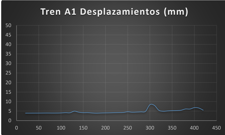
Figura 4.101 - Desplazamientos máximos tren A1 en arco de 100m de luz y relación 1/7.07
