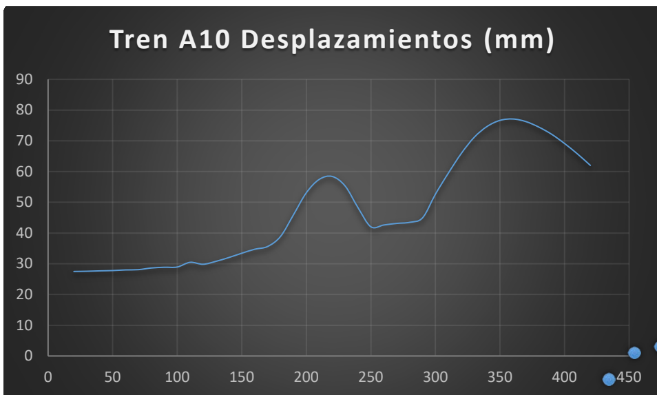
Figura 4.70 - Desplazamientos máximos tren A10 en arco de 300m de luz y relación 1/15
