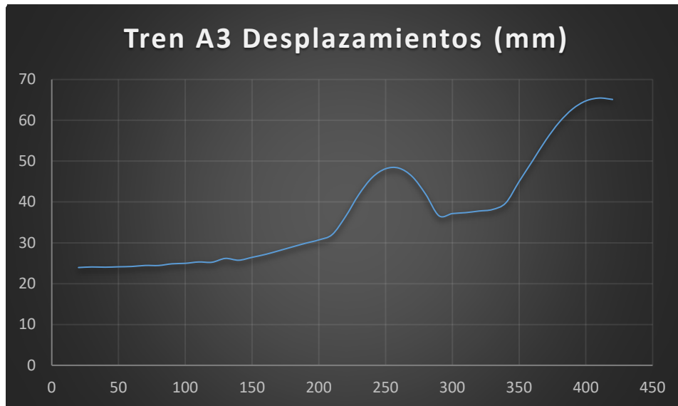
Figura 4.43 - Desplazamientos máximos tren A3 en arco de 300m de luz y relación 1/10
