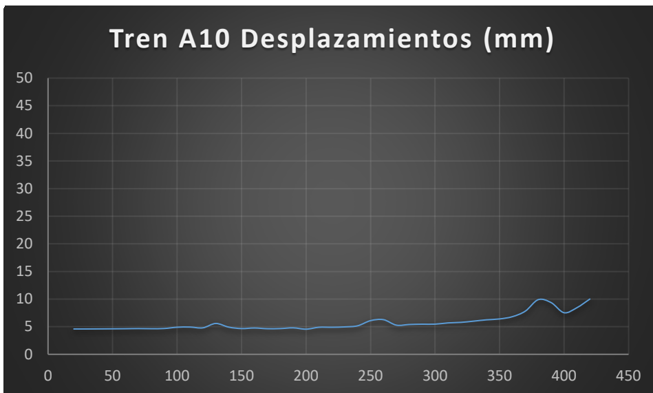
Figura 4.110 - Desplazamientos máximos tren A10 en arco de 100m de luz y relación 1/7.07
