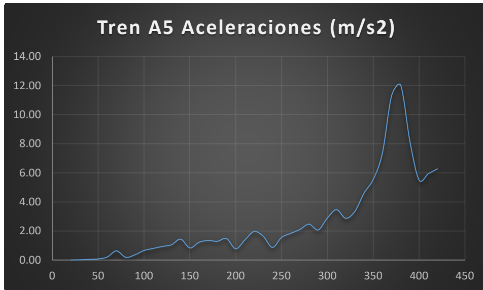
Figura 4.115 - Aceleraciones máximas tren A5 en arco de 100m de luz y relación 1/7.07
