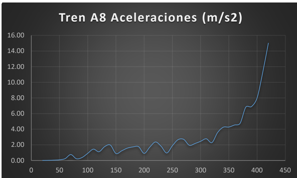
Figura 4.118 - Aceleraciones máximas tren A8 en arco de 100m de luz y relación 1/7.07
