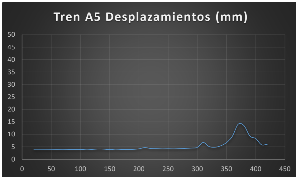
Figura 4.105 - Desplazamientos máximos tren A5 en arco de 100m de luz y relación 1/7.07
