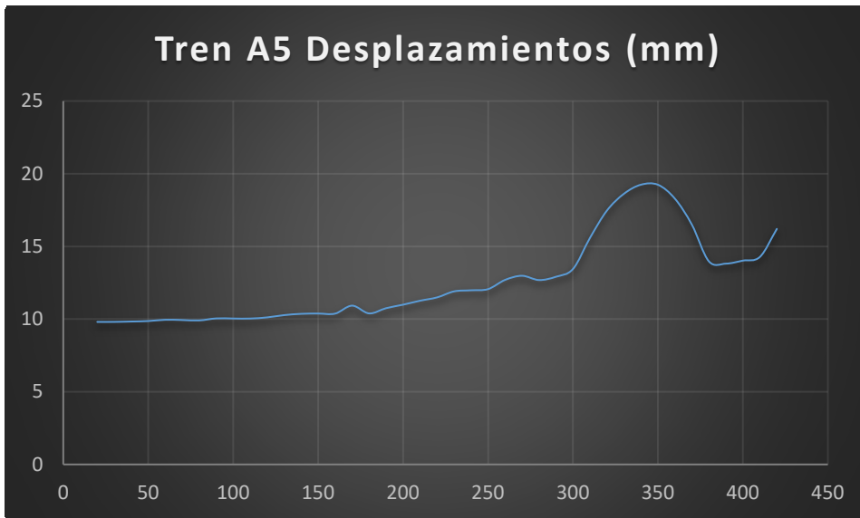
Figura 4.85 - Desplazamientos máximos tren A5 en arco de 200m de luz y relación 1/7.07
