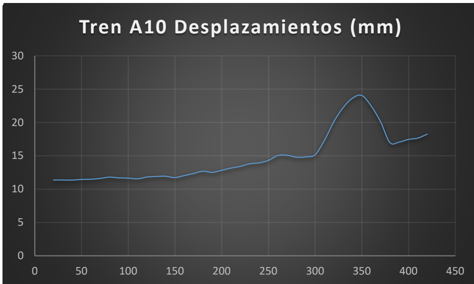
Figura 4.90 - Desplazamientos máximos tren A10 en arco de 200m de luz y relación 1/7.07
