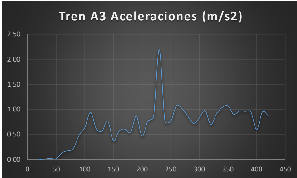
Figura 4.93 - Aceleraciones máximas tren A3 en arco de 200m de luz y relación 1/7.07
