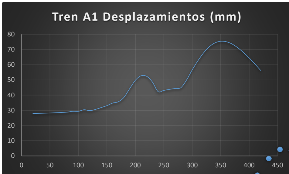
Figura 4.61 - Desplazamientos máximos tren A1 en arco de 300m de luz y relación 1/15
