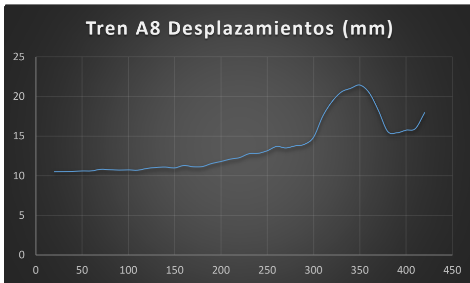
Figura 4.88 - Desplazamientos máximos tren A8 en arco de 200m de luz y relación 1/7.07
