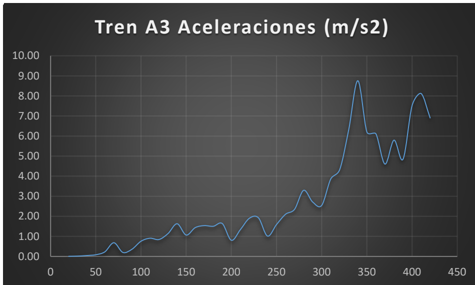
Figura 4.113 - Aceleraciones máximas tren A3 en arco de 100m de luz y relación 1/7.07
