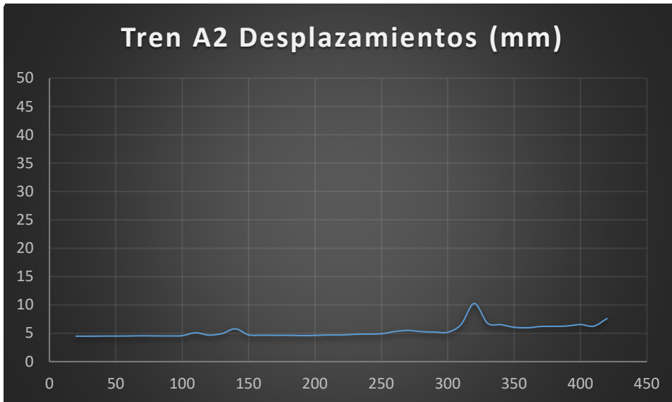
Figura 4.102 - Desplazamientos máximos tren A2 en arco de 100m de luz y relación 1/7.07
