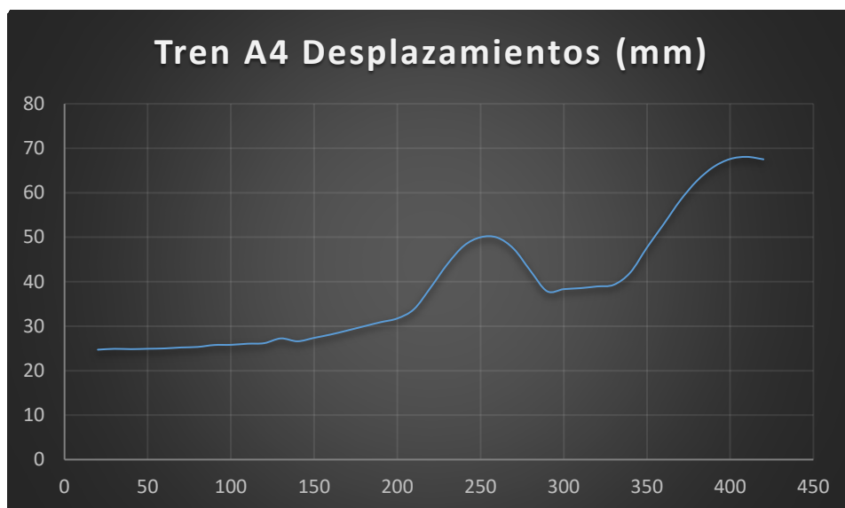
Figura 4.44 - Desplazamientos máximos tren A4 en arco de 300m de luz y relación 1/10
