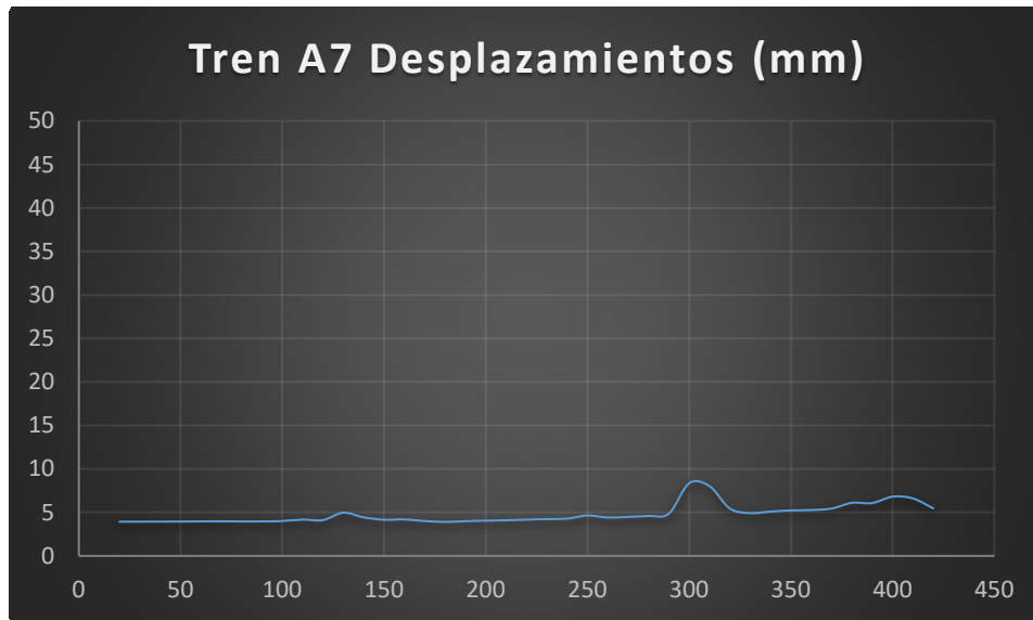
Figura 4.107 - Desplazamientos máximos tren A7 en arco de 100m de luz y relación 1/7.07
