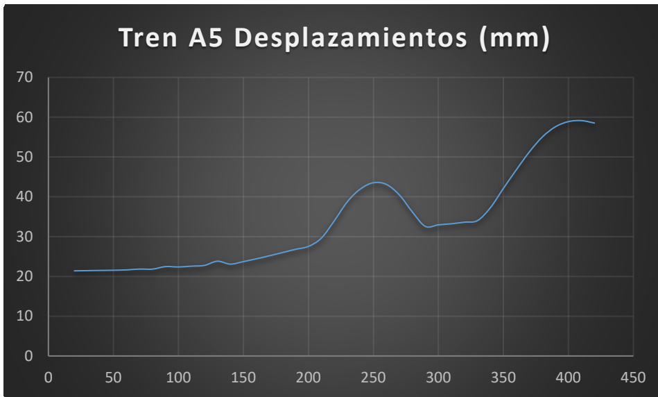
Figura 4.45 - Desplazamientos máximos tren A5 en arco de 300m de luz y relación 1/10
