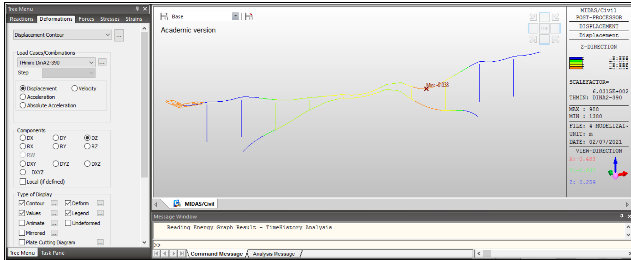
Figura 6.0.3 – Máximos desplazamientos arco de 300m de luz y relación f/l de 1/5
