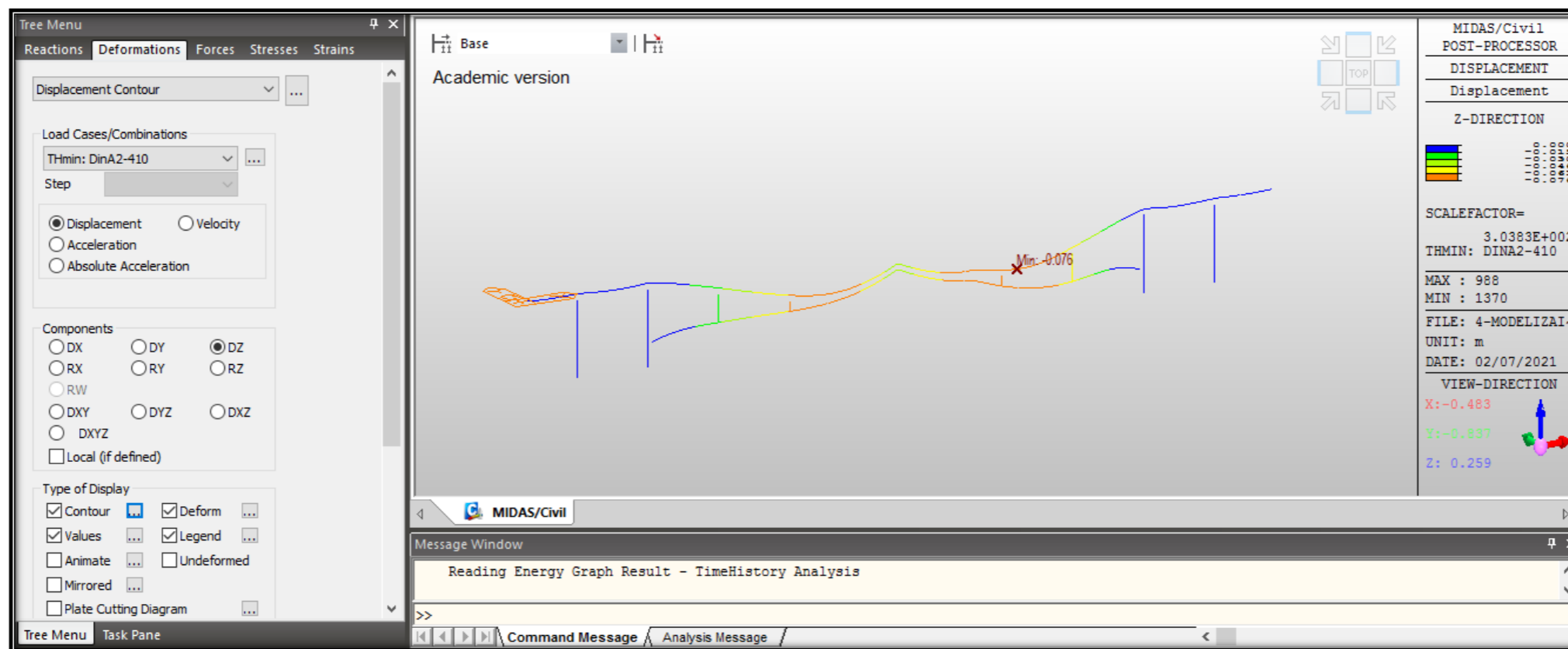
Figura 6.0.5 – Máximos desplazamientos arco de 300m de luz y relación f/l de 1/10
