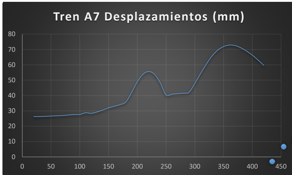
Figura 4.67 - Desplazamientos máximos tren A7 en arco de 300m de luz y relación 1/15
