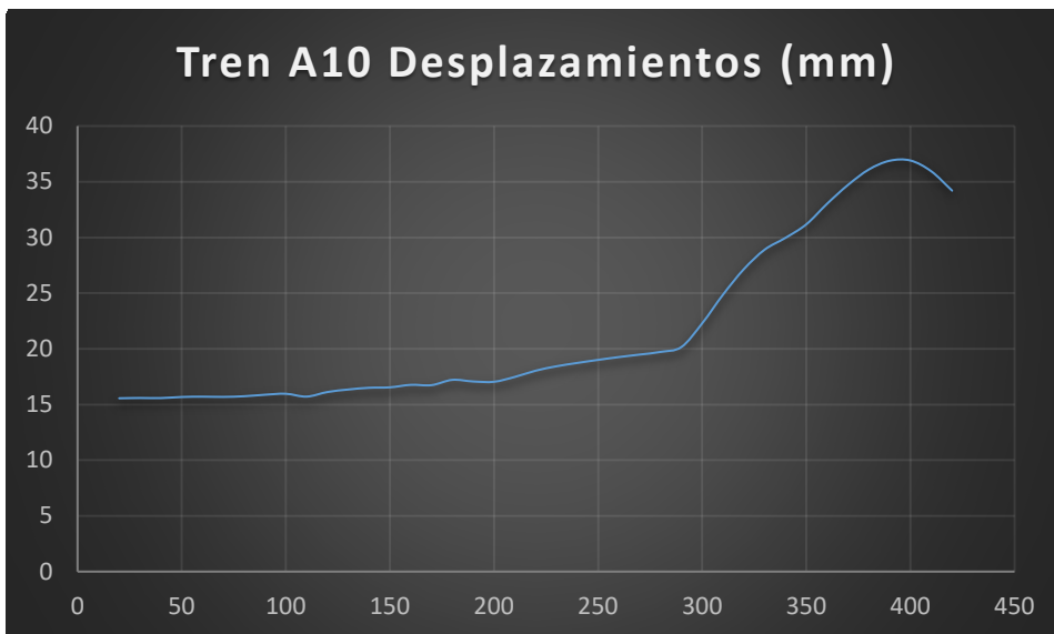
Figura 4.10 - Desplazamientos máximos tren A10 en arco de 300m de luz y relación 1/5
