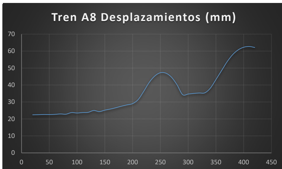
Figura 4.48 - Desplazamientos máximos tren A8 en arco de 300m de luz y relación 1/10
