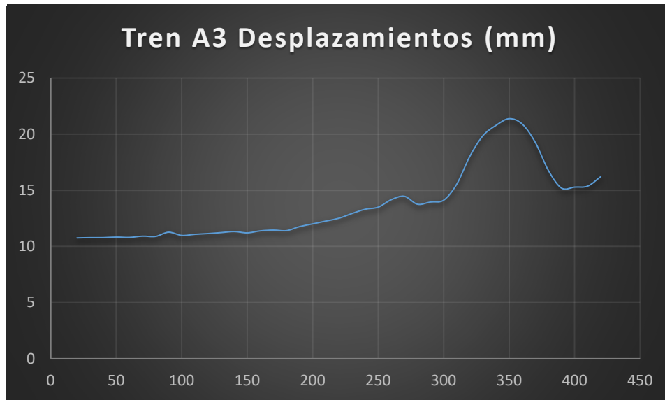
Figura 4.83 - Desplazamientos máximos tren A3 en arco de 200m de luz y relación 1/7.07
