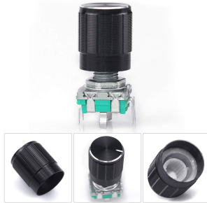
Figura 5.12 Encoder rotativo incremental (Fuente: amazon.es).
