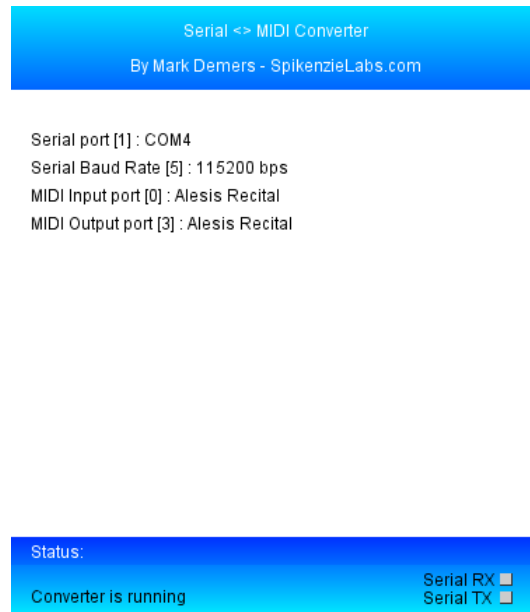
Figura 5.19 Vista del programa SerialMidi . COM4 es el puerto donde tenemos conectado el sintetizador y Alesis Recital es el nombre del teclado musical. El teclado aparece tanto en el puerto MIDI de entrada como el de salida, aunque el de salida no lo usaremos porque el sintetizador no genera ninguna señal MIDI..
