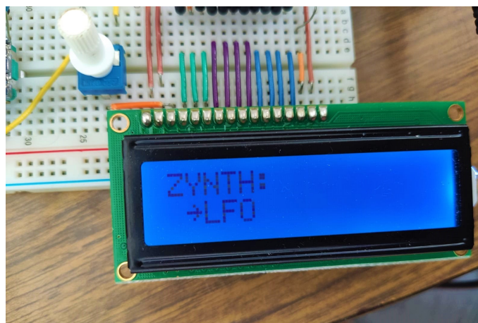
Figura 5.16 Módulo LCD. En la fila de arriba se muestra el nombre del menú actual. En la fila de abajo se van mostrando los submenús de los que se compone dicho menú actual. Zynth es el nombre del menú principal..
