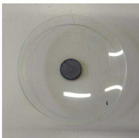
Figura 55. Muestra material ITM sobre vidrio de reloj antes de la pesada.
