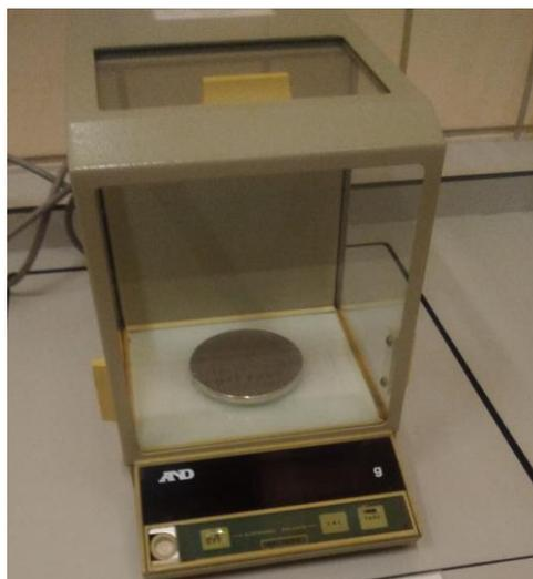
Figura 54. Balanza analítica de precisión.
