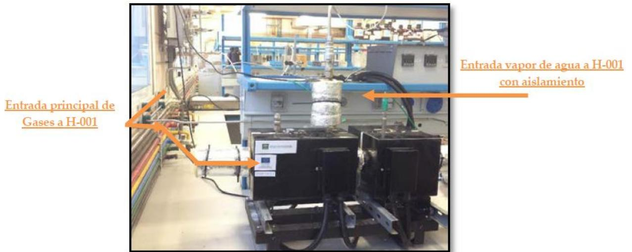
Figura 48. Entradas horno precalentador (H-001).
