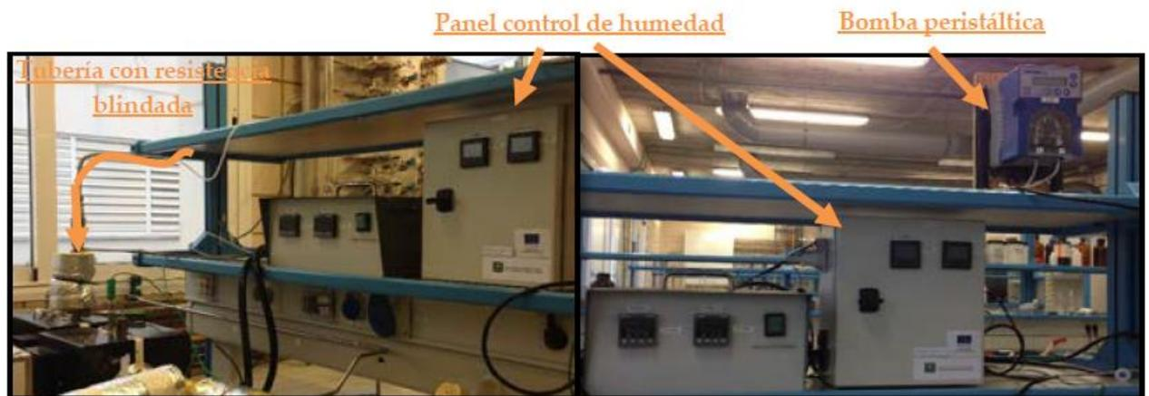
Figura 49. Sistema de inyección de vapor de agua.
