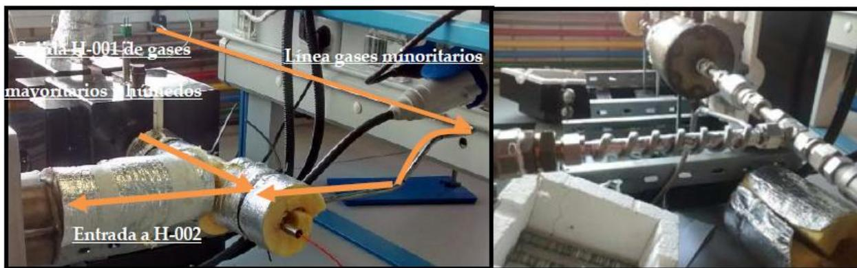
Figura 50. Línea de inyección de gases minoritarios.
