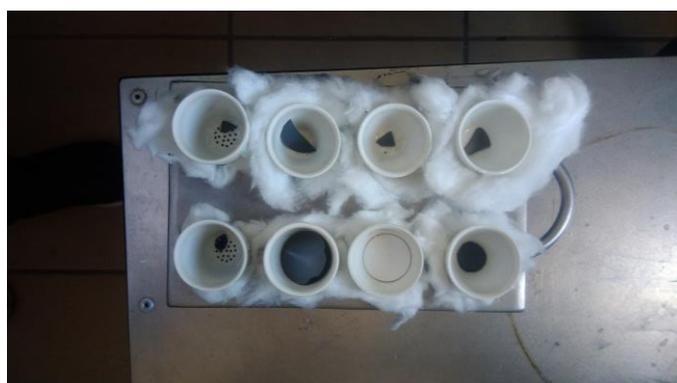
Figura 53. Muestras ITM contenidas en crisoles y colocadas en un portacápsulas.
