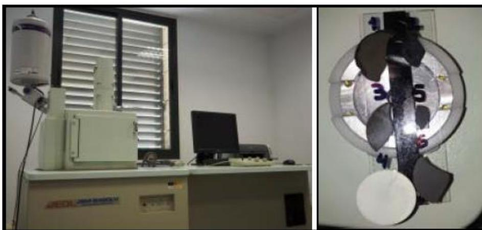
Figura 56. Microscopio electrónico de barrido y porta-muestras con muestras ITM soportadas en una placa de vidrio.
