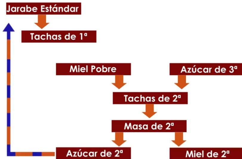
Ilustración 2-6 Esquema del proceso de cristalización del azúcar por Acor. Parte 3ª.
