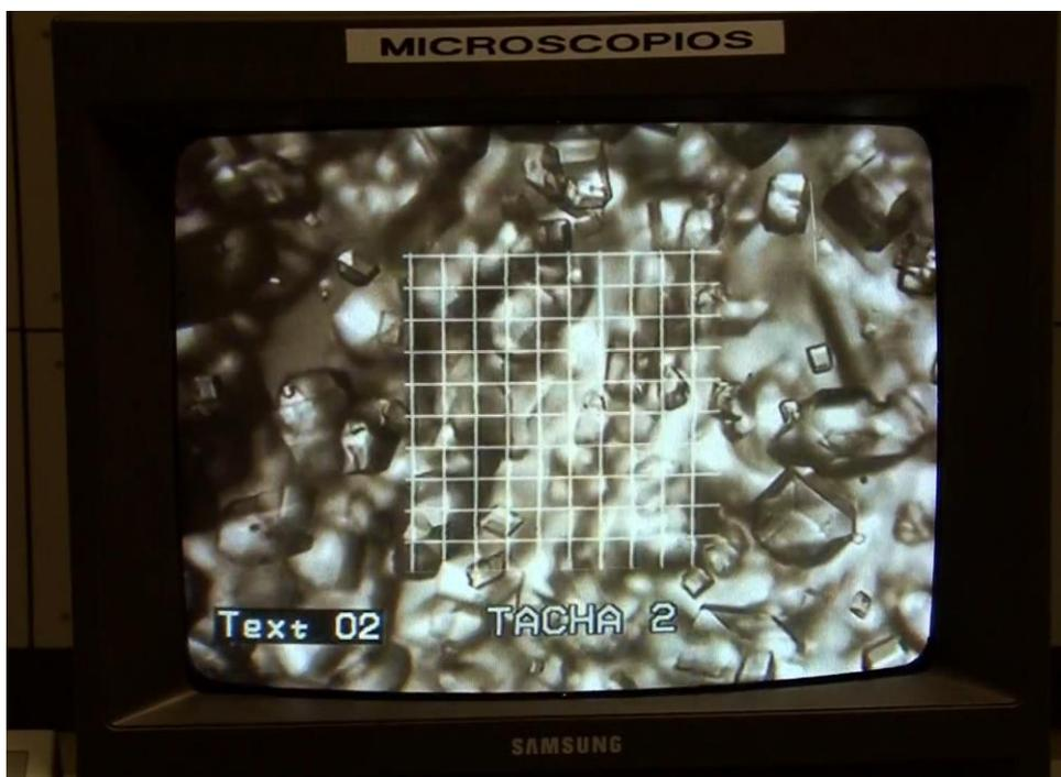
Ilustración 2-9 Monitor con rejilla para medir el grano de sacarosa (1º) [11]
