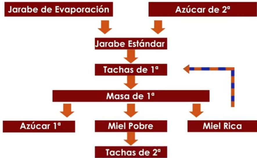
Ilustración 2-5 Esquema del proceso de cristalización del azúcar por Acor. Parte 1ª.
