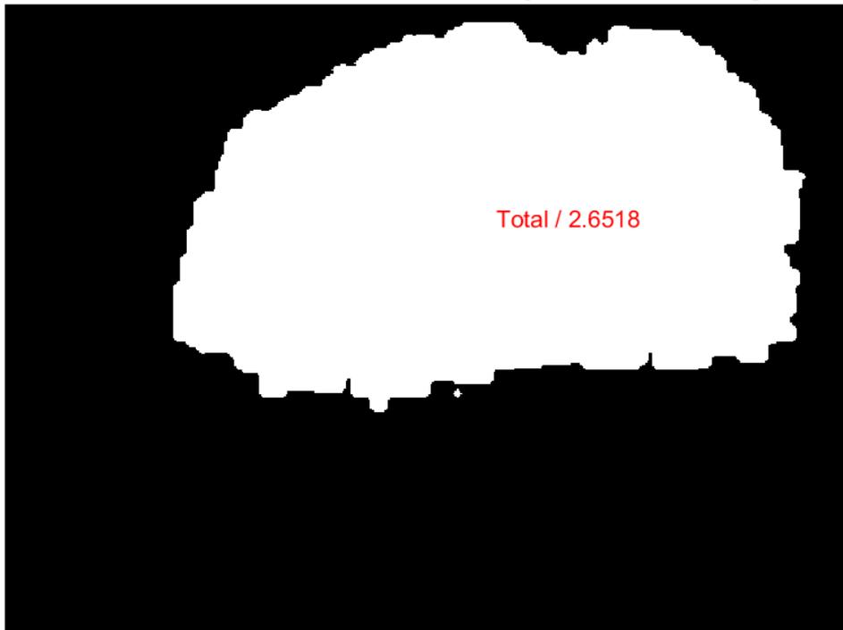
Ilustración 4-8 Ejemplo de desbordamiento de la binarización
