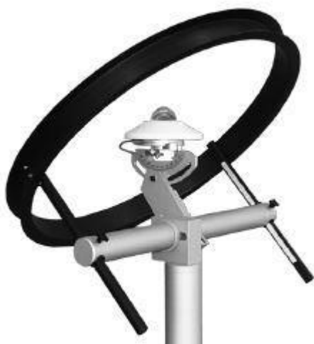
Figura 7. Piranómetro Kipp & Zonen CMP10 + banda de sombra.
