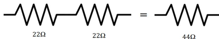
Figura 36: Unión de resistencias
