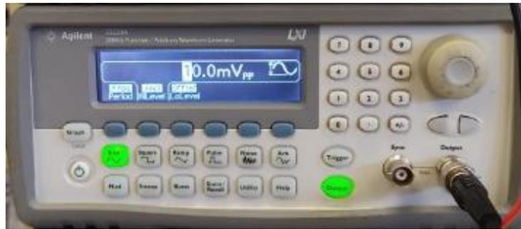
Figura 37: Configuración amplitud
