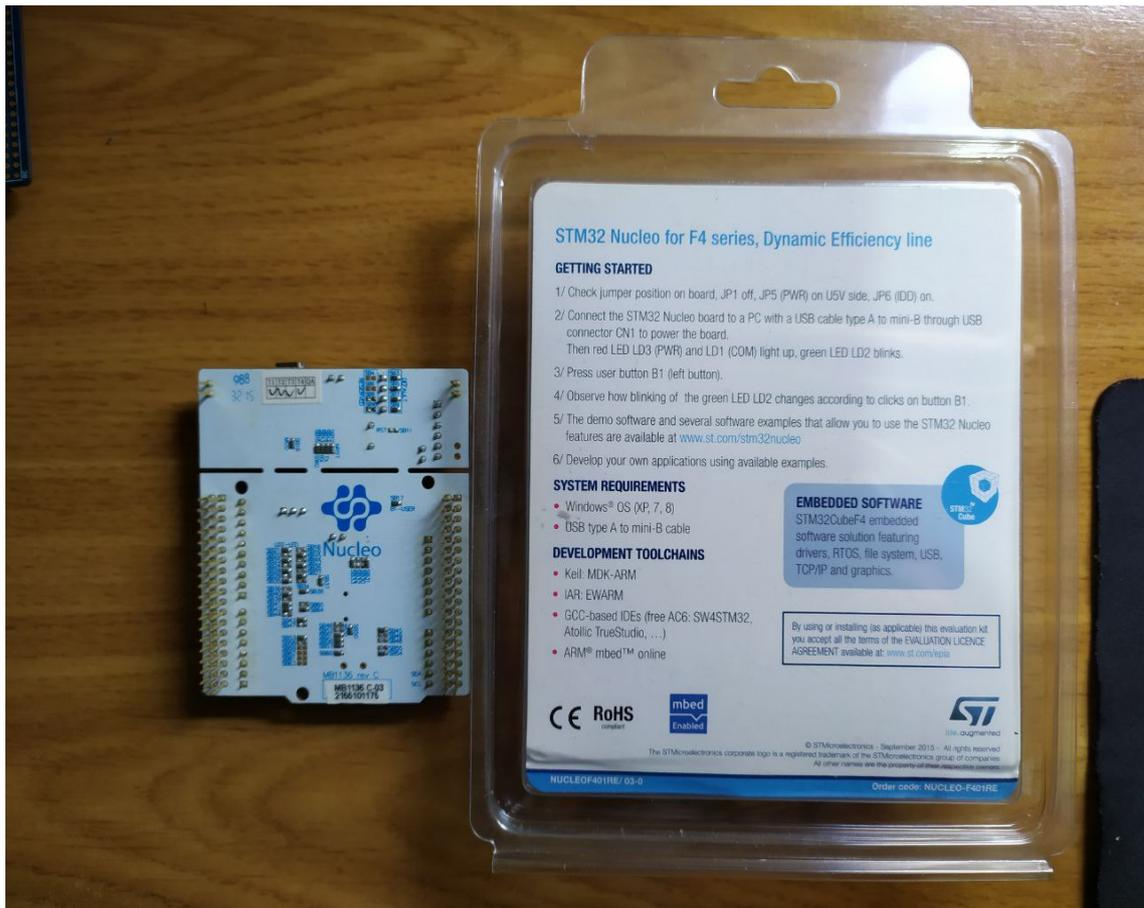
Figura 2.15 Placa de desarrollo Núcleo-64 STM32F401RE (parte de abajo).
