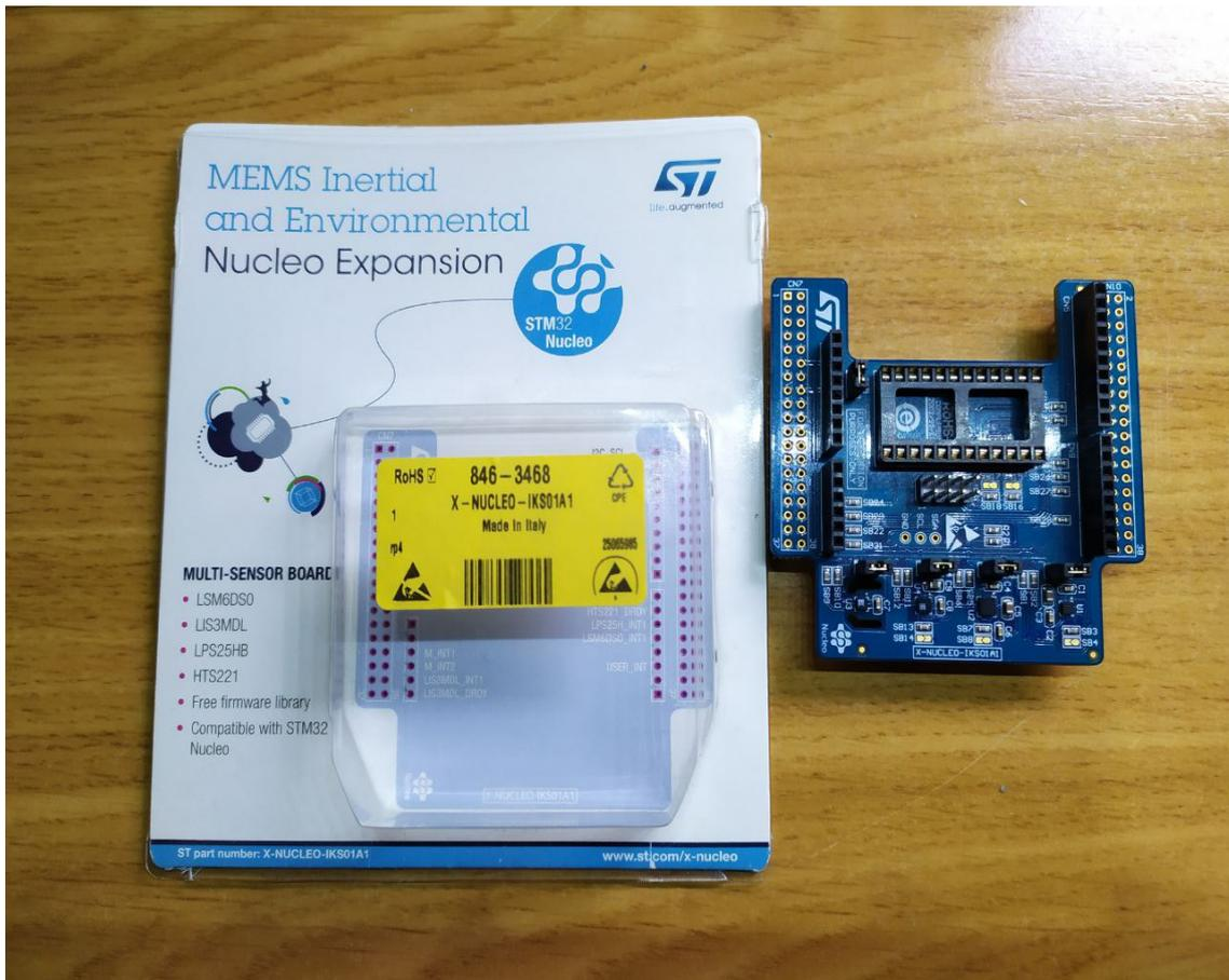
Figura 2.16 Tarjeta de expansión X-NUCLEO-IKS01A1 (parte de arriba).
