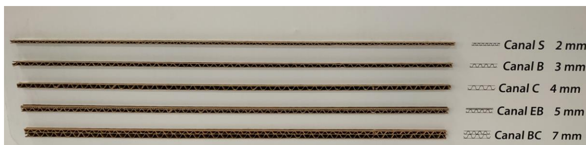
Figura 4: Tipos de canal en el cartón ondulado.
