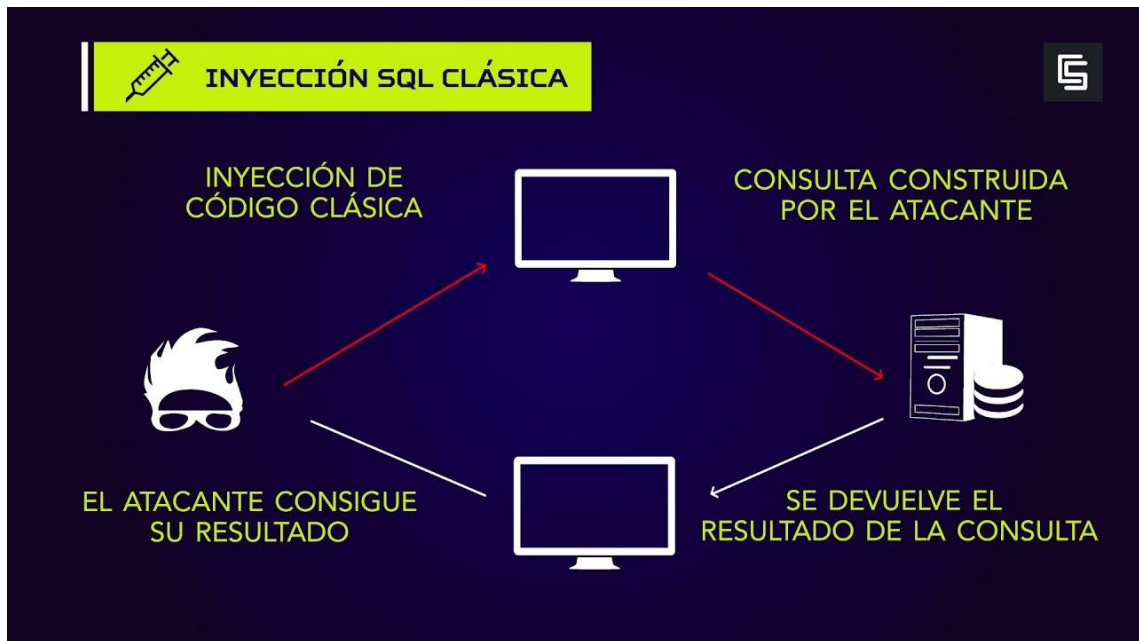
Figura 2: Esquema sencillo de realización de un ataque de inyección SQL. Fuente: Universidad Rey Juan Carlos
