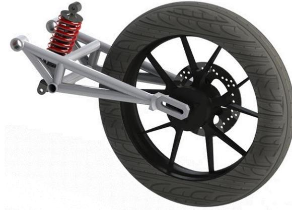
Figura 5-1: Diseño de un basculante de doble brazo de una motocicleta.
