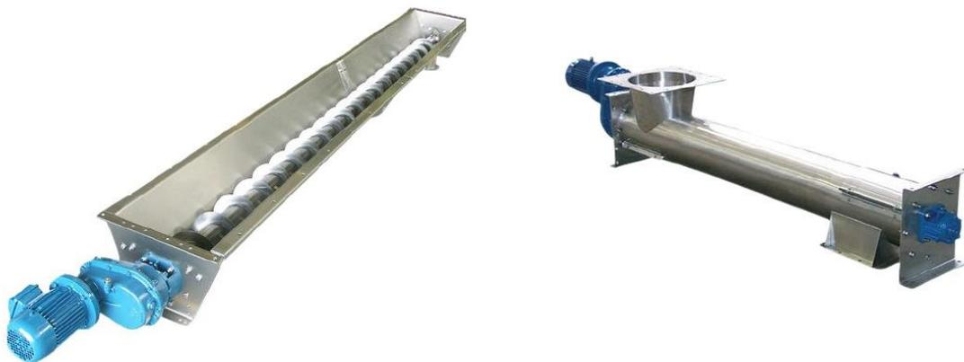
Los sistemas de alimentación mecánica basados en tornillos sinfín son susceptibles de quedar bloqueados por trozos de biocombustible que excedan el límite dimensional, especialmente cuando los tornillos sinfín están dentro de un tubo. En los casos de transporte por canal, los bloqueos son menos frecuentes, aunque se han de utilizar motorizaciones sobredimensionadas debido al mayor caudal circulante.
