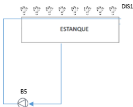
Figura 54. Esquema disipación estanque anfiteatro
