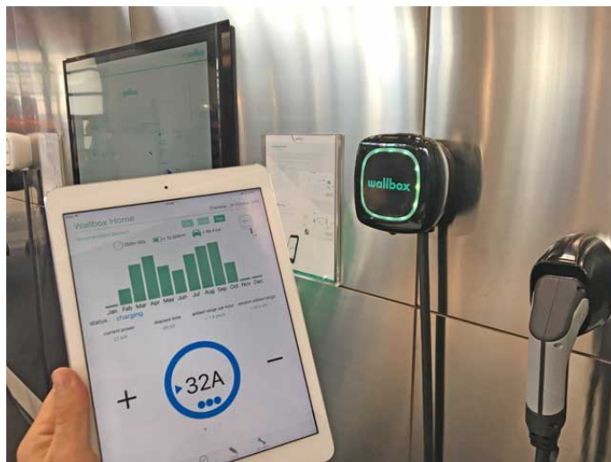
Figura 1.17 Estación de carga WallBox. Fuente: https://forococheselectricos.com/2016/11/wallbox-llega-espana-con-sus-puntos-de-recarga-commander-y-pulsar.html .
