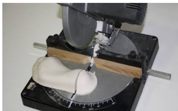
Figura 4 Corte del molde en la zona de talón para valorar la simetría. Imagen propia.
