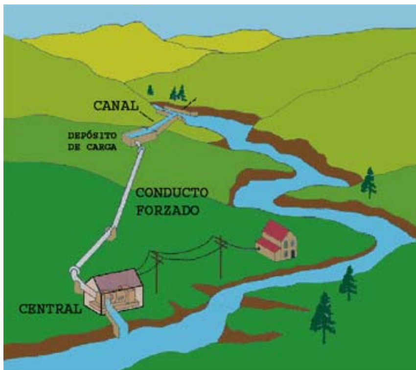
Figura 3.11. Esquema de una central hidráulica de agua fluyente [9].
