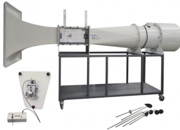
Figura 12. Túnel de viento de ciclo abierto [26]
