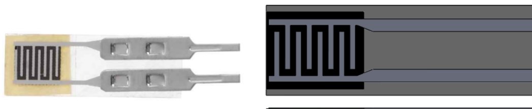
Figura 5-12. Sensor de fuerza RP-C18.3-ST [39] y su modelo 3D. Elaboración propia en SolidWorks®
