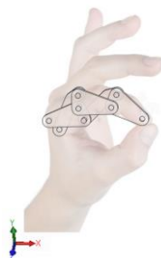
Figura 5-1. Situación del mecanismo del dedo índice -análogo para los dedos 3, 4 y 5.
