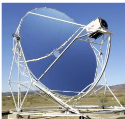
Figura 3.6. Reflector parabólico dish-Stirling. (baunetzwissen, n.d.)
