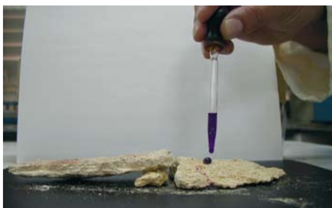
Imágenes del ensayo de gotas, donde todas las muestras se ensayaron por su intradós y su trasdós. Fotos: María Gracia Gómez de Terreros
