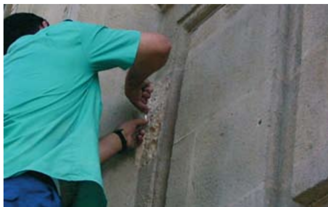
Imágenes de la toma de muestras en la fachada. Puede apreciarse la heterogeneidad en el espesor de las costras y el aspecto de la superficie pétreo sobre las mismas. Fotos: María Gracia Gómez de Terreros
