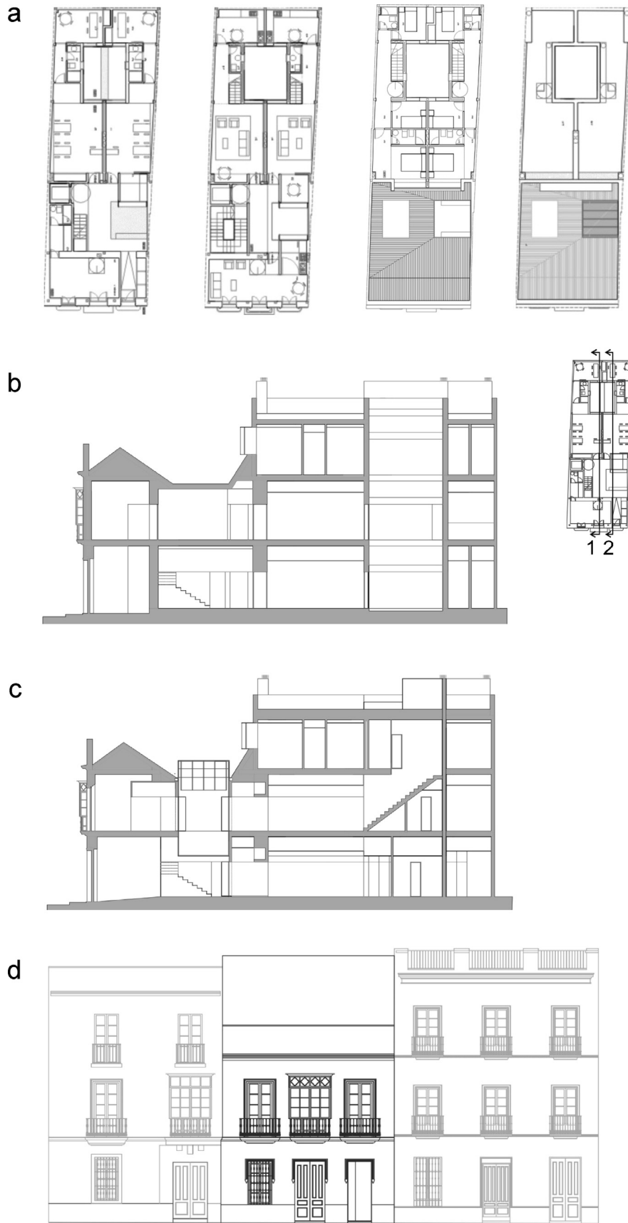
Fig. 3. Model B. (a) Plans, (b) Section 1, (c) Section 2 and (d) elevation.
