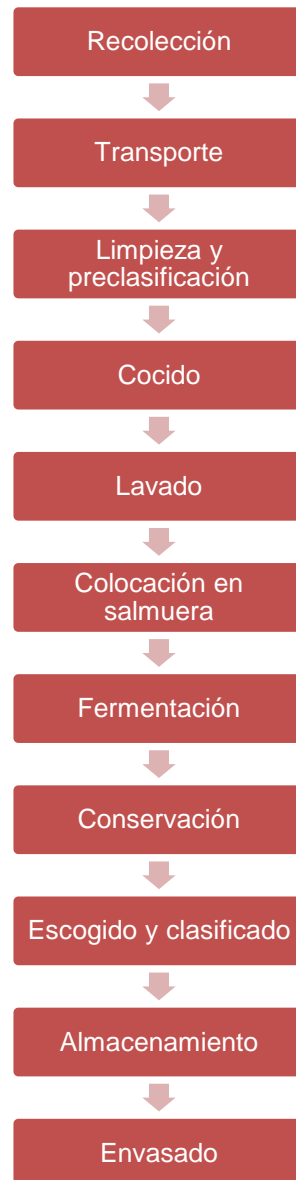
Ilustración 5.11. Etapas de la elaboración de aceitunas verdes al estilo español o sevillano. (Elaboración propia)
