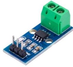
Figura 5: Sensor ACS712 de efecto Hall
