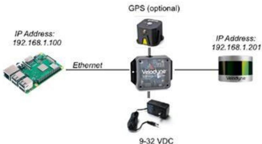
Figura 3-47. Conexiones del hardware
