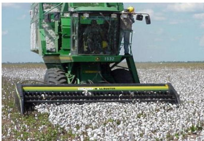
Figura 3.1: Cosechadora con sistema stripper.
