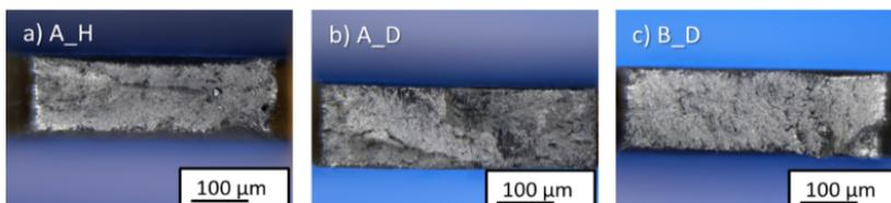
**Figura 3.** Imágenes ópticas de las superficies de fractura de especímenes extraídos: a) pieza hecha con polvo de Ti6Al4V cortada horizontalmente; b) pieza hecha con polvo de Ti6Al4V cortada diagonalmente; c) pieza hecha con alambre de Ti6Al4V cortada diagonalmente.
