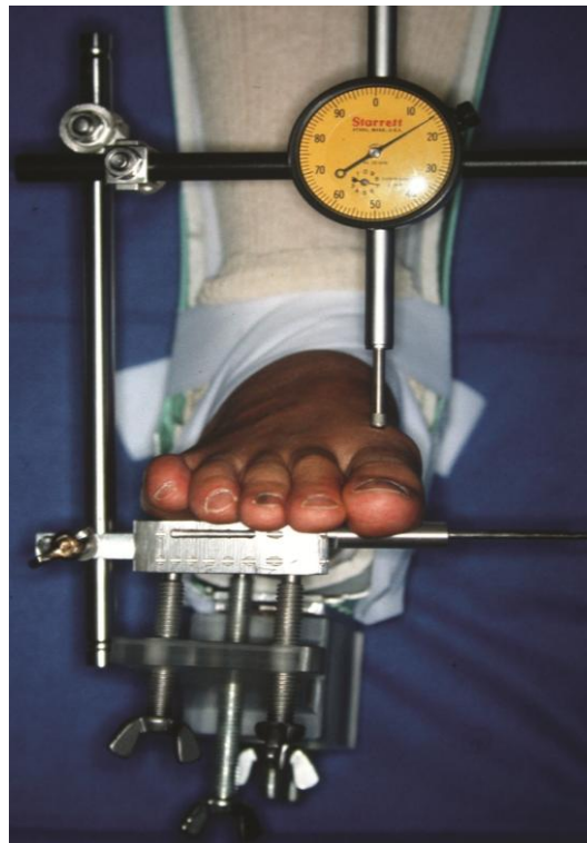
Figura 5. Instrumento de Klaue et al 12 para la exploración de la movilidad dorsal del primer radio. Reproducida con el permiso de Kaj Klaue
