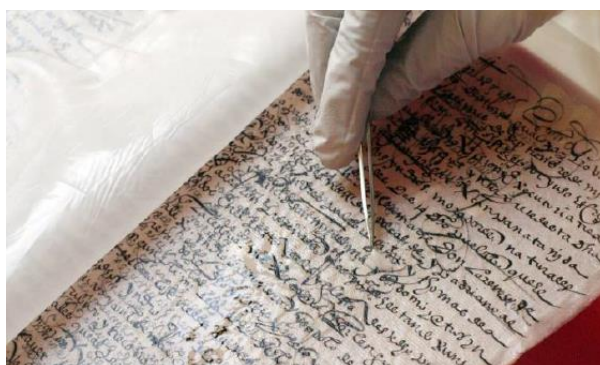
Figura 51. Aplicación de la prueba con papel indicador de iones de hierro Fe^{2+} sobre el documento húmedo (Odor, 2013)
