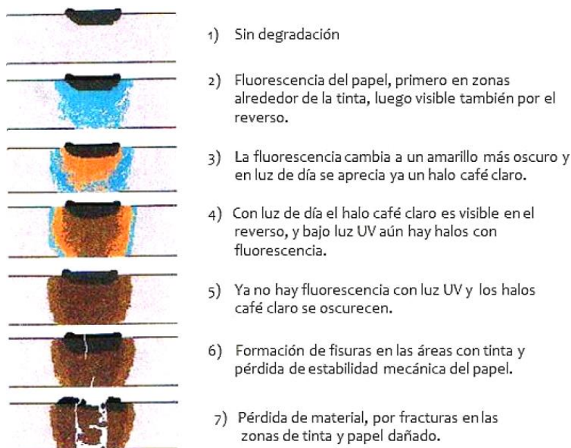
Figura 41. Esquema del proceso de degradación del papel causado por tintas ferrogálicas (Odor, 2013)
