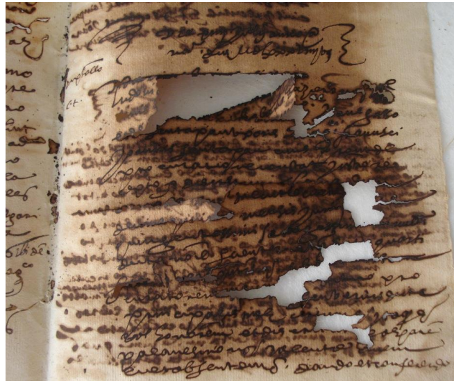
Figura 19. Acción oxidante de las tintas ferrogálicas sobre el papel (Trestaller, 2020)
