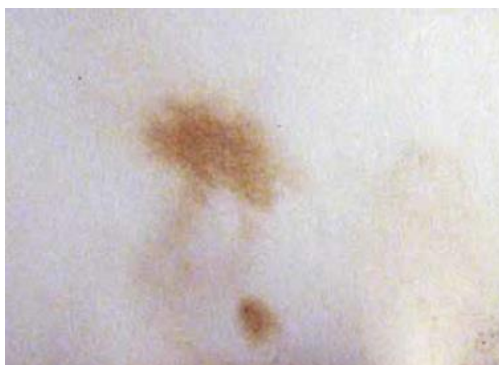
Figura 39. Manchas por migración de la acidez del soporte (Grañén, 2010)
