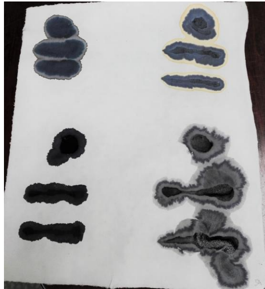
Figura 36. En la parte superior se aprecian las tintas de hierro y cobre recién aplicadas tras su elaboración. En la zona inferior del soporte se observan los trazos de las tintas tras una espera de 10 días (García, 2019)
