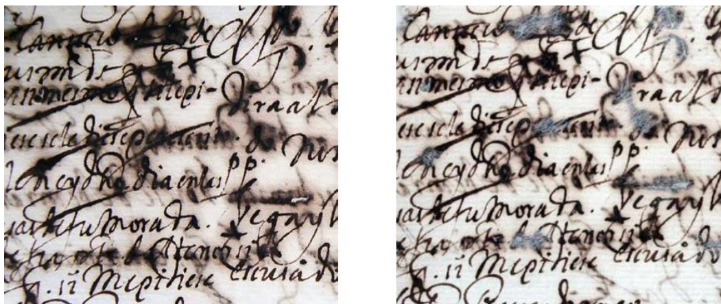
Figura 59. Documento con corrosión de la tinta antes y después del tratamiento de estabilización mecánica no acuosa (Odor, 2013)
