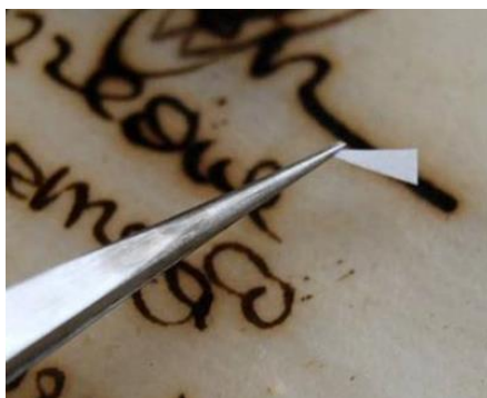
Figura 50. Aplicación de la prueba con papel indicador de iones de hierro Fe^{2+} (Odor, 2013)
