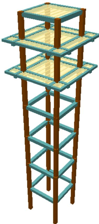
Figura 3-4. Modelo en 3D de la estructura de hormigón armado
