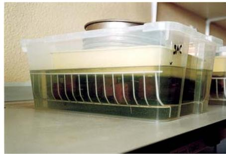
Figura 5. Cubeta de humectación con rejilla de suspensión y peso superior.
