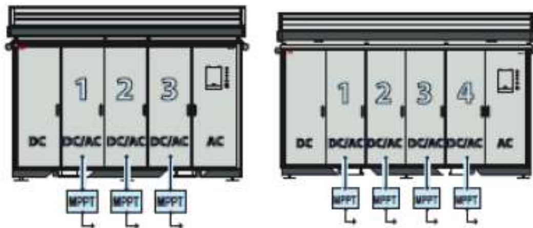
Figura 3.12.1.2 Esquema de los modelos de los inversores de 1050 kW (izquierda) y de 1400 kW (derecha).
