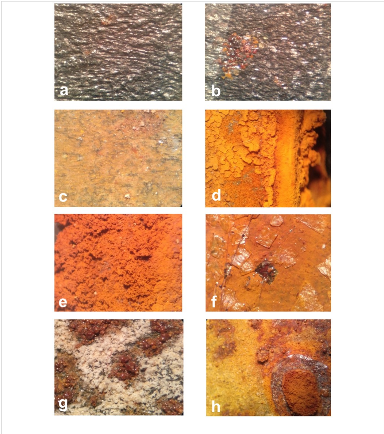
Figura 23, 24, 25, 26, 27, 28, 29 y 30. Observación con microscópico estereoscópico de 40x. Figura 23. (a) Superficie del hierro antes del proceso de corrosión. Figura 24. (b) Mácula puntual y heterogénea de coloración marrón-amarillenta en la muestra experimental in situ protegida con Paraloid B72®. Figura 25. (c) Pátina uniforme de la probeta sometida a agua de lluvia y protegida con Paraloid B72®. Figura 26. (d) Laminación de la zona de la muestra experimental sin protección y sometida a agua de lluvia. Figura 27. (e). Superficie pulverulenta perteneciente a la probeta protegida con Paraloid B72® sometida a la disolución de 20% de sal. Figura 28. (f) Cristalización de sales en la superficie de la probeta protegida con Incral 44® y sometida a una disolución de 100% de sal. Figura 29. (g) Depósitos de sales y concreciones en la superficie de la muestra experimental protegida con Paraloid B72® sometida a un medio acuoso con una concentración de sal al 100%. Figura 30. (g) Pitting presente en la zona sin protección de la probeta sometida a agua de mar.
