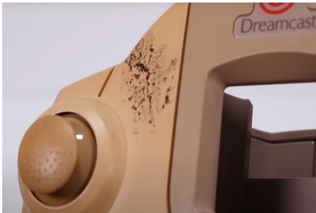
Fig 21. Arañazos, amarilleamiento e hidrólisis en un controlador de Dreamcast©. ODD Tinkering, 2020. Disponible en: https://www.youtube.com/watch?v=xDKCMrn2Ff0
