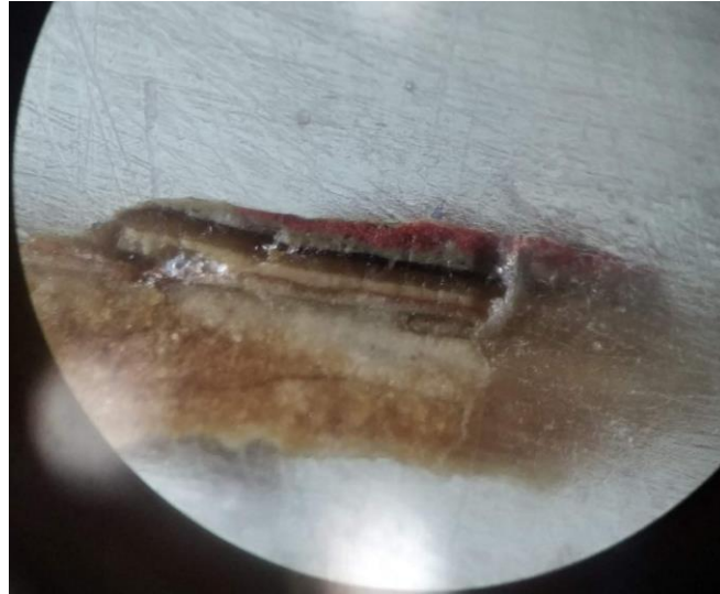
Fig.36. Ejemplo de estratigrafía de una escultura vista desde un microscopio estereoscópico. Se aprecian los diferentes estratos (cola animal, estuco, policromía...). Facultad de Bellas Artes (2018/2019) 144 .
