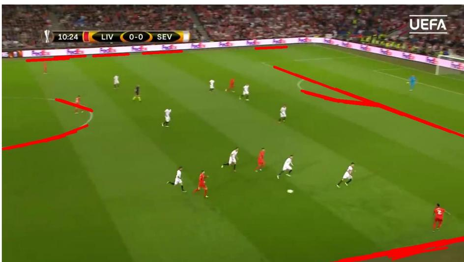
Ilustración 2.8 Detección de rectas con transformada de Hough
