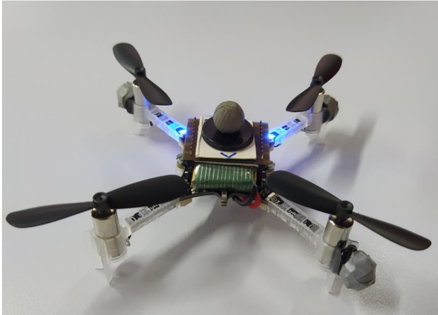
Figura 3-7. Colocación de los marcadores.
