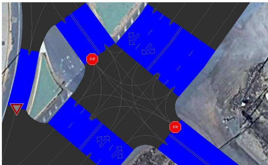
Ilustración 4-6. Ejemplo de “lane connector” en una intersección.
