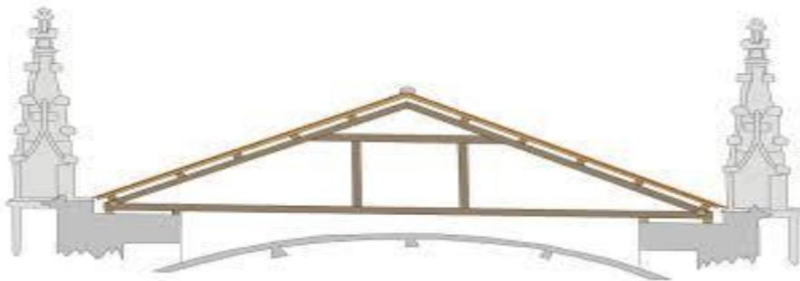
*Ilustración 24. Cercha de madera para la cubierta de una catedral.
