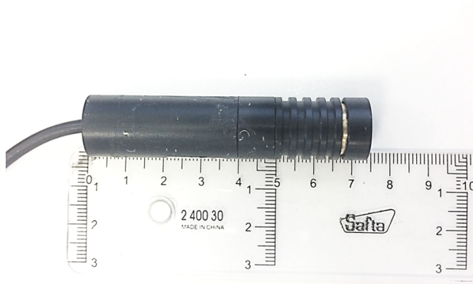
Figura 2.5 Láser rojo de proyección plana.
