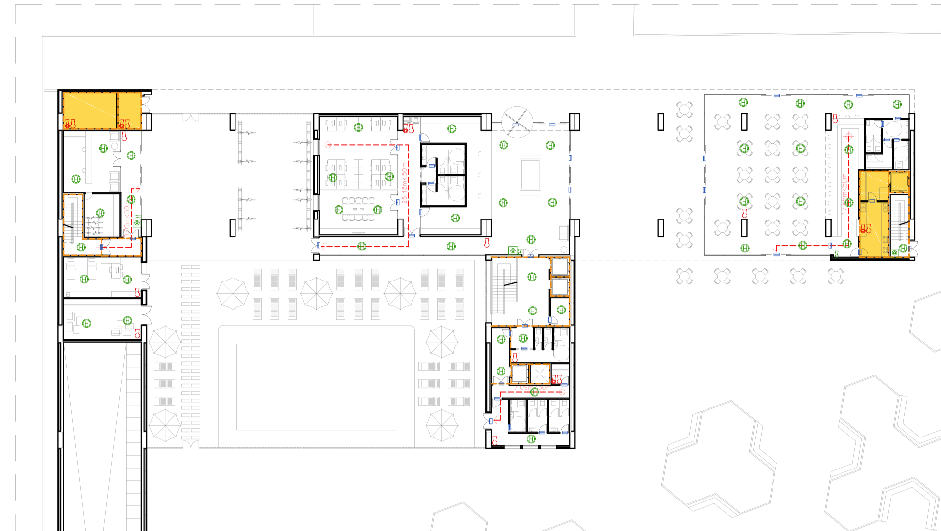
PROTECCIÓN CONTRA INCENDIOS. PLANTA BAJA
