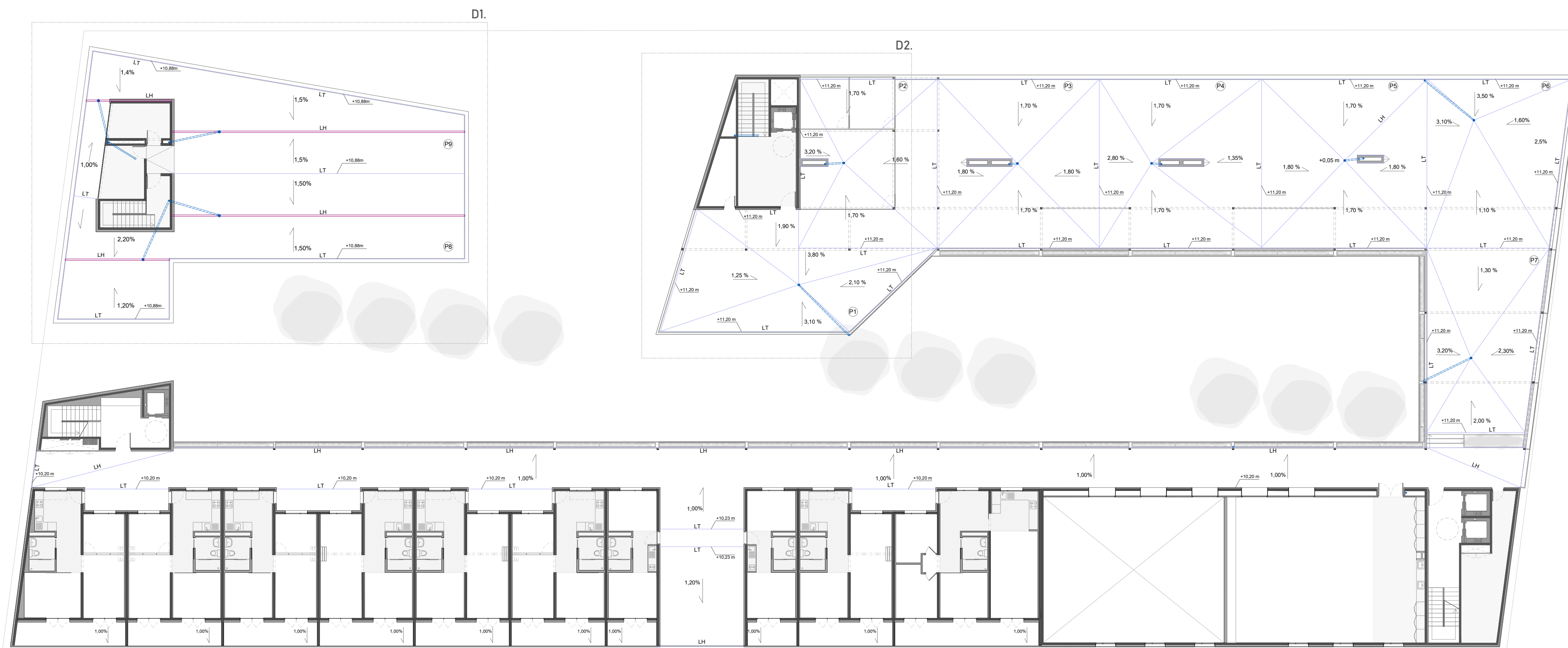
PLANTA TERCERA: EVACUACIÓN DE AGUAS PLUVIALES_E 1/200
