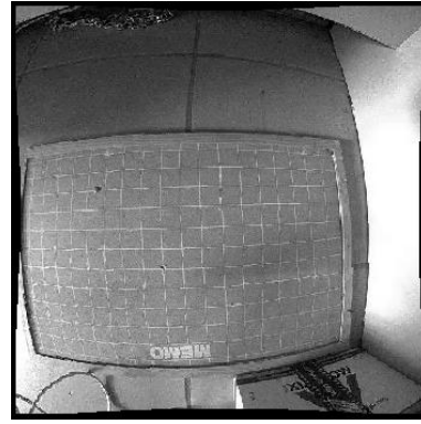
Figura 1: Imagen cuadriculada para la obtención de los parámetros intrínsecos de la cámara.
