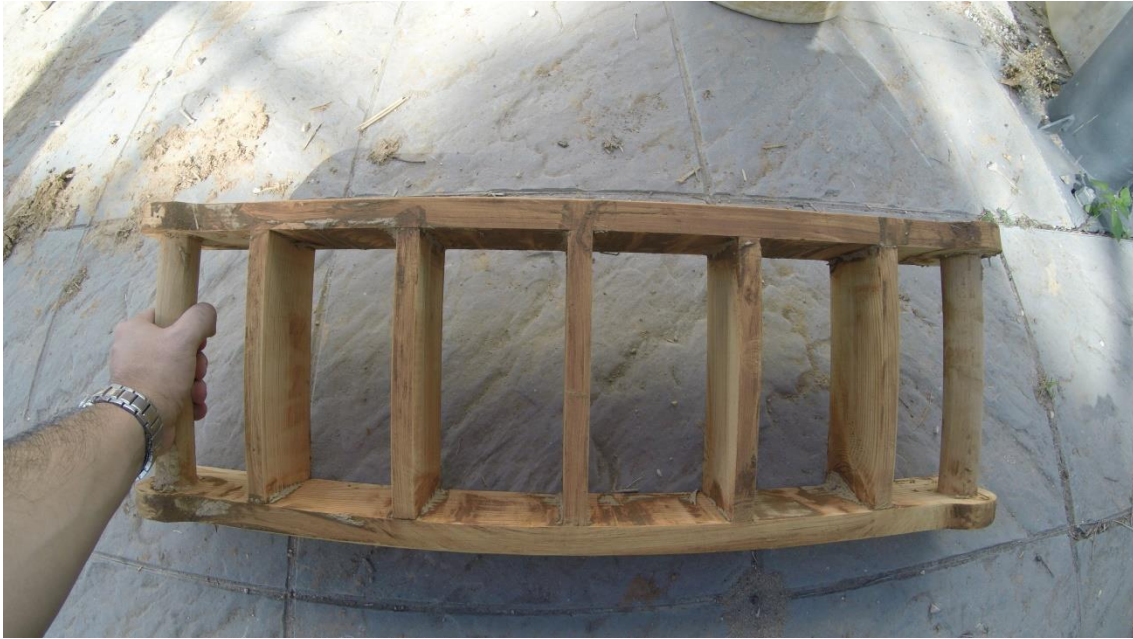
Ilustración 65 - Molde para producción de ladrillo de Adobe. Fuente propia.
