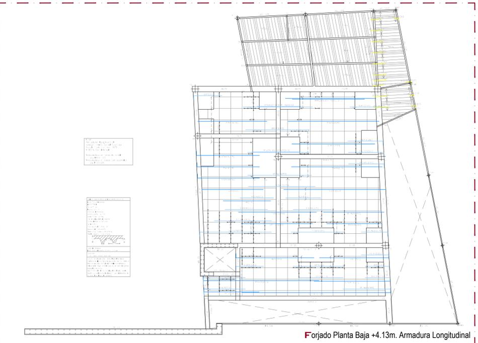
Forjado Planta Baja +4.13m. Armadura Longitudinal
