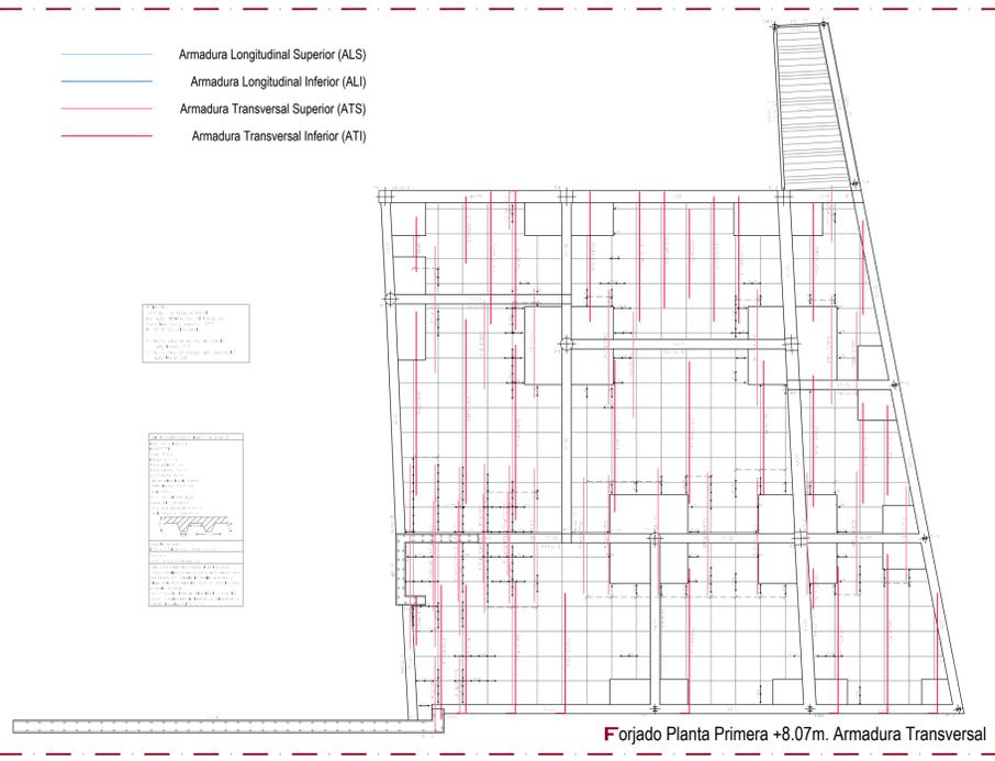
Forjado Planta Primera +8.07m. Armadura Transversal
