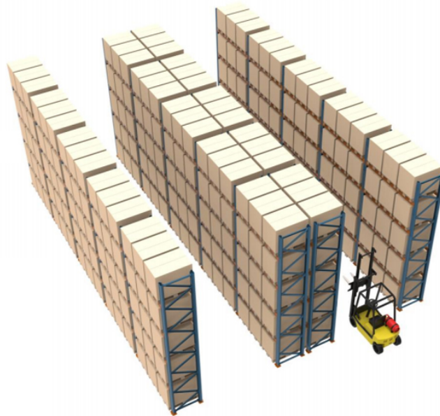
Figura 2.15 Ilustración de un sistema de almacenamiento basado en estanterías convencionales [Craftsman Storage Systems, 2020].
