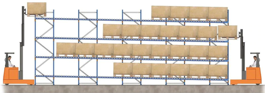
Figura 2.13 Esquema de un sistema de estanterías dinámicas. Se aprecia la posibilidad de una carga y descarga simultáneas debido a que las carretillas no interfieren entre sí [Mecalux S.A., 2020b].
