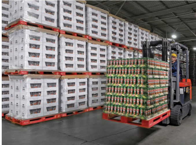
Figura 2.9 Sistema de almacenado mediante apilado en suelo. El peso de cada palé recae sobre los que se encuentran por debajo de él [The Shelby Report, 2011].
