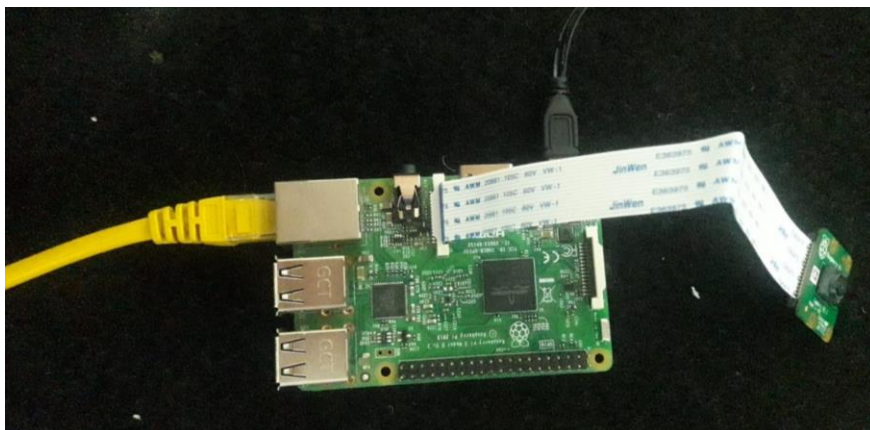
Figura 4-53: Montaje de Raspberry Pi 3 con cámara
