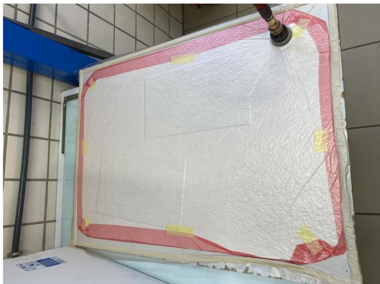
**Figura 14.** Bolsa de vacío utilizada para la compactación de los laminados.
