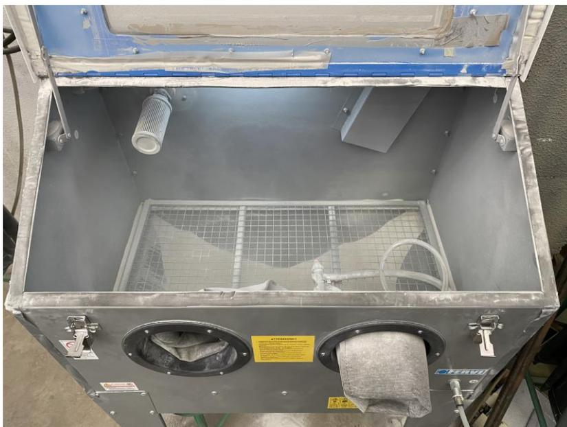
**Figura 17.** Pistola de chorro de arena utilizada para lijar las superficies a encolar.
