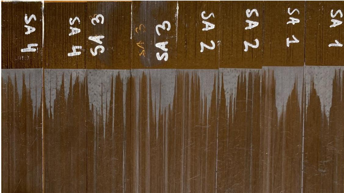
**Figura 26.** Modo de fallo de curado sin adhesivo.
