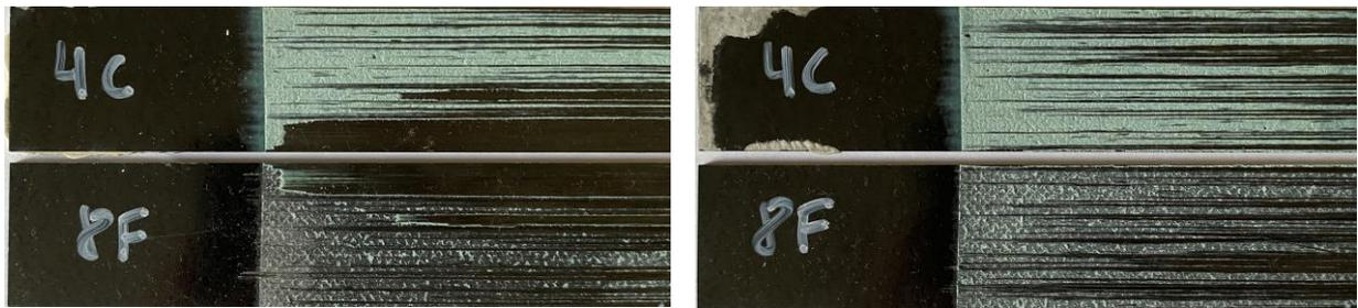
En ambos casos el fallo vuelve a ser adhesivo con presencia de delaminación, quedando el adhesivo en el adherente curado previamente.
