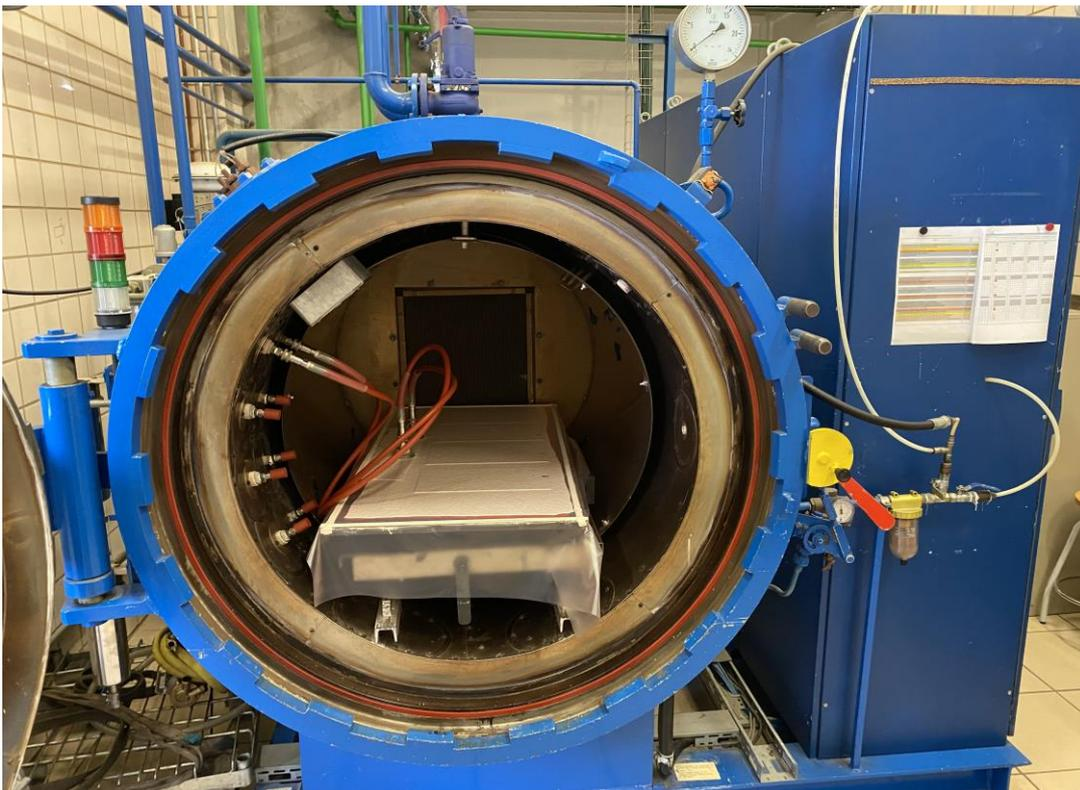
**Figura 16.** Autoclave del LERM utilizado para el curado de paneles.
