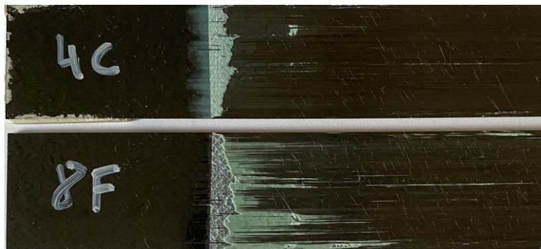
**Figura 34.** Modo de fallo de la probeta 4C8F\_4.
