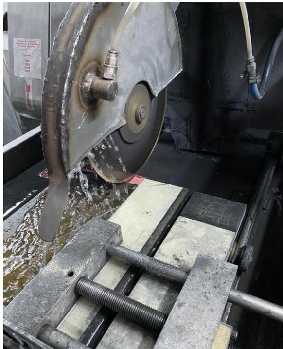
**Figura 19.** Sierra de disco de diamante utilizada.
