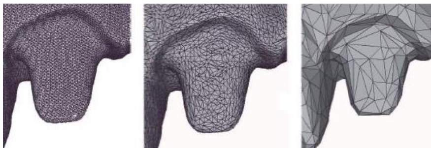
Figura 1: En la imagen vemos de izquierda a derecha: nube de puntos, malla de puntos y reconstrucción (8).
